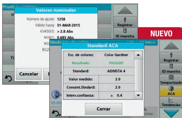
Filtros de verificación certificados, soluciones standard reproducibles "addista-color" y una aplicación integrada de medidas de aseguramiento de calidad analítica (AQA-ACA) aseguran una óptima fiabilidad de medida.
