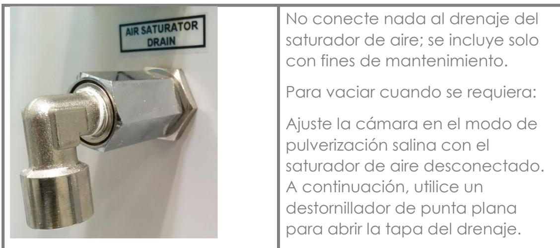
Nota: Si la cámara no se utiliza durante un periodo de tiempo, se recomienda vaciar el saturador de aire para evitar la acumulación de algas, que pueden producir obstrucciones del sistema, o de bacterias, que pueden entrañar posibles riesgos para la salud.
