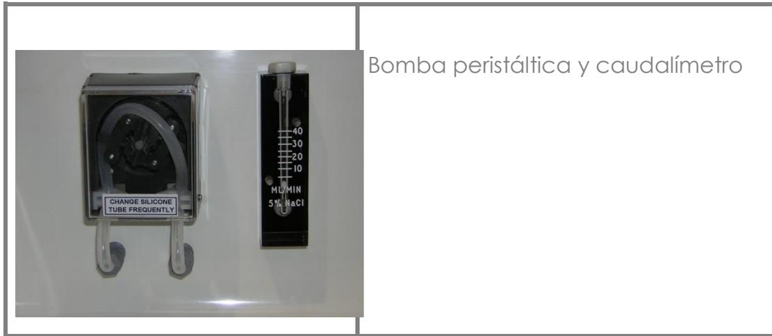
El caudalímetro monitoriza el caudal de la solución salina desde el depósito hasta el atomizador. La bomba peristáltica extrae la solución salina del depósito y la envía al atomizador.
