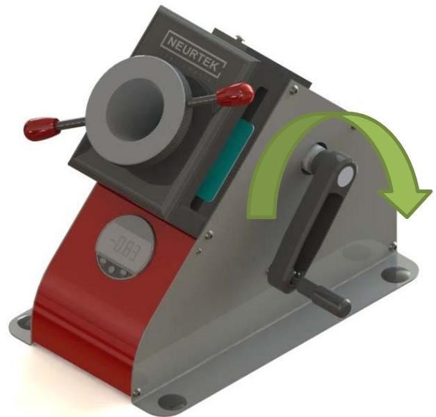
Mientras subimos observamos la probeta por el interior del cono, pudiendo ver cómo se va produciendo la deformación.
