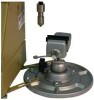
Un aspecto esencial para el uso del Abrasímetro Lineal es sujetar la muestra en su lugar a lo largo del ensayo.
