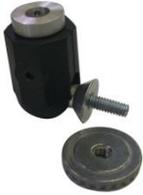
Consiste en realizar un ensayo de fricción arrastrando el material sobre la superficie. El útil de sujeción roscado, permite posicionar la herramienta abrasiva o la pieza a ensayar. Los materiales pueden incluir calzo, copa cerámica, objetos plásticos, etc.
