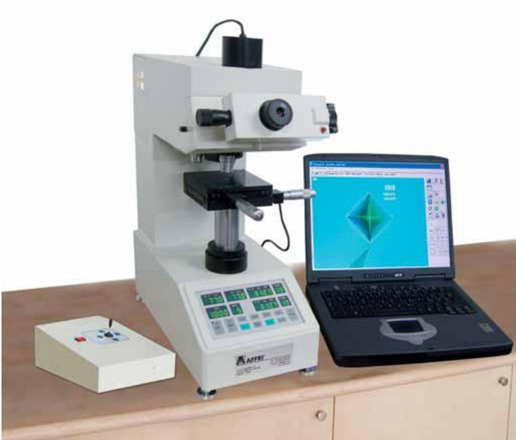
El Emicrodurómetro DM2 puede efectuar ensayos de microdureza en un amplio rango de materiales teniendo en cuenta las normas EN ISO 6507, ASTM E384 y JISB7734.
