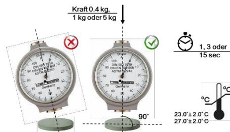
Raumtemperatur, Anpresskraft und Messzeit sind aus den entsprechenden Normen zu entnehmen und einzuhalten.
