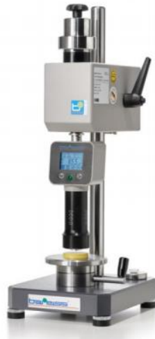
Soporte Automático BSA con velocidad de descenso de 3,2 mm/s según normas.
