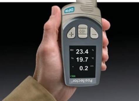
La pantalla abatible permite la visualización del lado derecho hacia arriba en cualquier posición. Se muestra el PosiTector DPM A.
