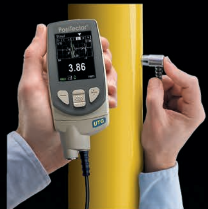
UTG M Medición a través de la pintura mide el espesor del metal de una estructura pintada sin tener que quitar el revestimiento
