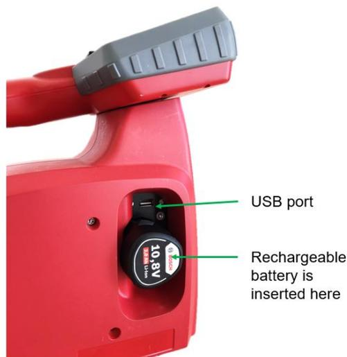
*Inserte la batería recargable en el costado del LTL3000.*
