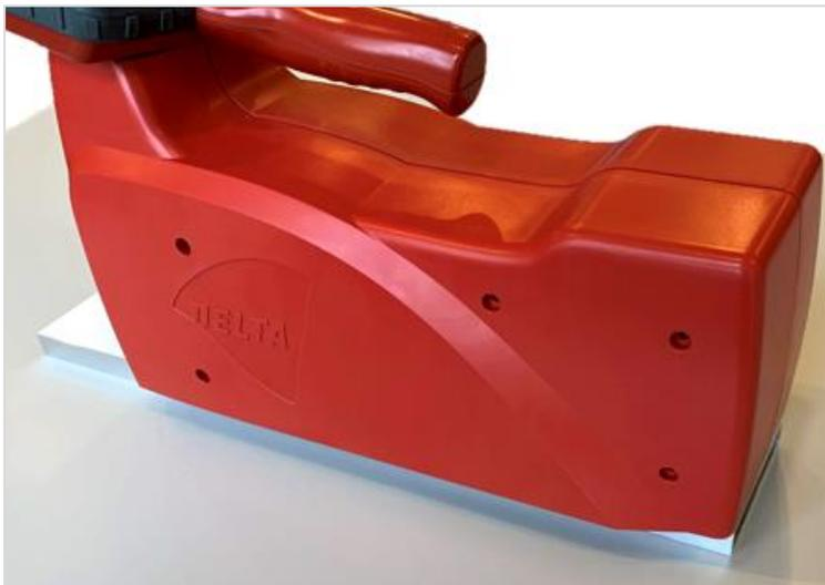
*Para calibrar el valor Qd, coloque el LTL3000 sobre el objetivo de calibración Qd.*
