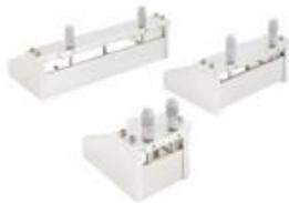
Aplicador de película de humedad, con dos micrómetros integrados que permiten ajustar la hoja (cuchilla) de modo que la distancia de la hoja se gradúa en pasos de 10µ desde 0 a 6 mm. Fabricado en acero inoxidable. Otros anchos disponibles. Consultar.
