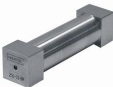
Aplicador cilíndrico de cuatro alturas de aplicación definidas: 30, 60, 90 y 120 micras o 50,100, 150 y 200 micras. Disponible en 2 anchos: 50 y 80 mm.
