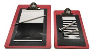
Elemento auxiliar para barras de aplicación espiral y resto de aplicadores manuales. Sirve para sujetar las cartulinas de contraste.
