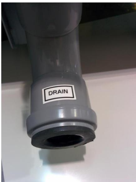
El drenaje de condensado se encuentra en la parte posterior de la cámara de ensayos de humedad. Conéctelo a una tubería de 40 mm de diámetro.
