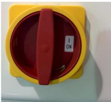
Un interruptor giratorio de aislamiento eléctrico está instalado en una posición destacada en la cámara. Este interruptor permite aislar la cámara del suministro eléctrico (fase y neutro) al colocarlo en la posición '0' y puede bloquearse en esta posición en caso necesario. El suministro eléctrico está conectado cuando este interruptor se sitúa en la posición '1'.
