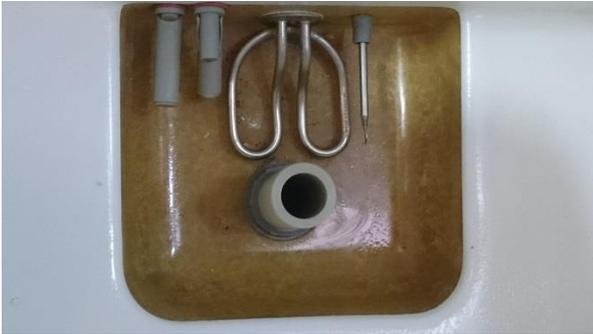
El aliviadero de drenaje de la cámara debe estar siempre colocado cuando se utiliza la cámara.
