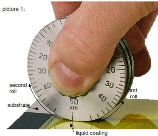
Haciendo rodar el medidor por un revestimiento húmedo, llega un momento en que la rueda central hace contacto con la película. Este punto de la escala indica el espesor.
