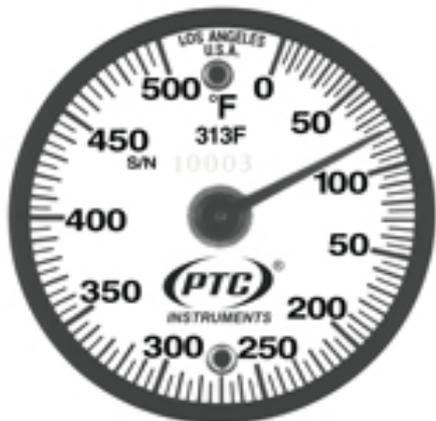
Los termómetros de contacto, están especialmente concebidos para medir temperaturas de todo tipo de piezas ferromagnéticas, debido a que en su base tienen dispuestos dos imanes y, en medio de ambos, una membrana que mide la temperatura real de la pieza. Los imanes permiten un buen anclaje del termómetro.
