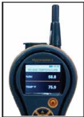
Figura 4: El HygroMaster 2 como higrómetro
