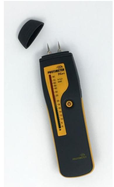
Se trata un sencillo, portátil y manejable instrumento capaz de determinar el grado de humedad de los materiales de construcción. El resultado se obtiene a través del contacto de sus dos electrodos con la superficie a medir y se visualiza en una escala de diodos led de diferentes colores.
