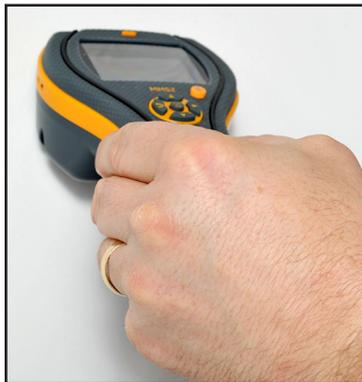
Figura 2: Uso del medidor de humedad con clavijas
