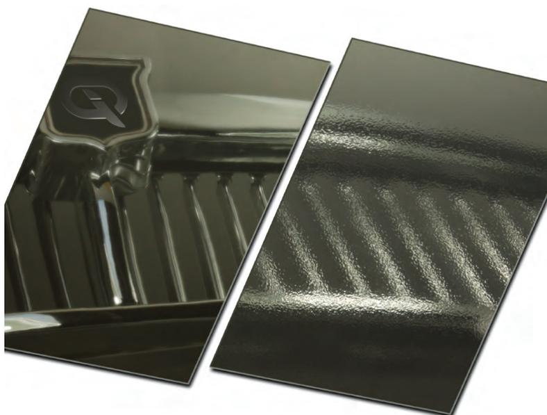
La textura de la superficie puede reducir la calidad de la apariencia, sin afectar al brillo. Estas dos probetas de ensayo tienen lecturas idénticas cuando se miden con un brillómetro estándar.
