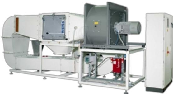
El método MIL-STD-810 510.7 se utiliza para evaluar la resistencia de los materiales a entornos con arena y polvo, adaptados a condiciones ambientales específicas y requisitos de materiales. Este método es relevante para una amplia gama de dispositivos mecánicos, ópticos, eléctricos, electrónicos, electroquímicos y electromecánicos en industrias en las que se prevé dicha exposición.
