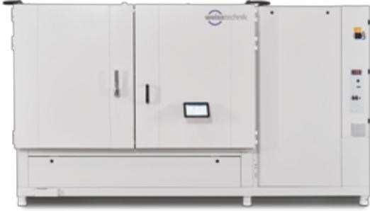
El método 507.6 simula condiciones climáticas cálidas y húmedas en dos variantes: ciclos inducidos y naturales. El objetivo es evaluar los efectos de la alta humedad en los materiales y componentes. Los riesgos típicos incluyen corrosión, pérdida de aislamiento, deformación de materiales y fallos funcionales. El método permite realizar pruebas realistas y respalda el desarrollo de productos robustos para entornos operativos exigentes con un alto estrés climático.
