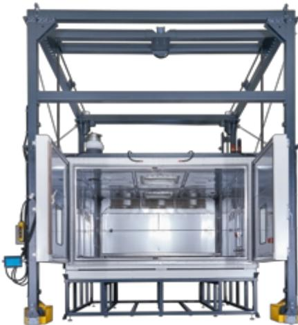
El método «Vibraciones mecánicas de los equipos a bordo» evalúa los efectos de las vibraciones mecánicas en la seguridad operativa, la estabilidad estructural y la funcionalidad de los materiales y equipos a bordo. La prueba incluye vibraciones ambientales e inducidas internamente, así como la supervisión de cambios físicos o funcionales. Las vibraciones pueden provocar el deterioro de los materiales, el fallo de los componentes y la pérdida de rendimiento.
