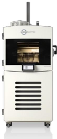
El método 503.7 (choque térmico) evalúa la capacidad de un elemento de ensayo para soportar cambios repentinos y extremos en la temperatura ambiente. Simula transiciones rápidas entre entornos calientes y fríos para evaluar la integridad estructural y la fiabilidad operativa. Esto permite identificar los mecanismos de fallo en caso de fluctuaciones repentinas y extremas de temperatura. Por ejemplo, las piezas mecánicas pueden deformarse o fallar debido a diferentes expansiones térmicas.
