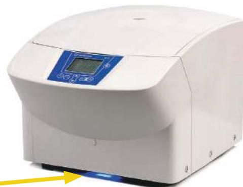
Iluminación LED indicadora de funcionamiento de la centrifuga
