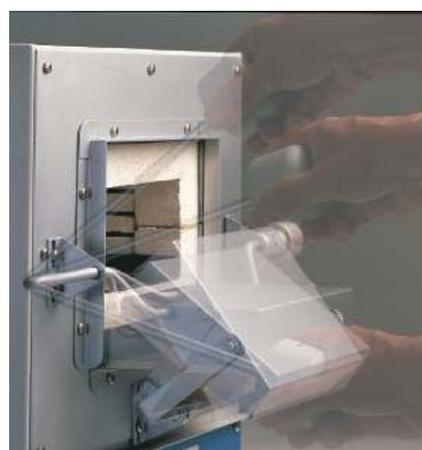
Detalle del sistema de apertura basculante.
