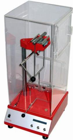
El péndulo está preparado para funcionar con ambos sistemas indistintamente, con una simple conmutación en el cuadro electrónico de mando incorporado se puede utilizar el sistema Persoz o el König. Hay que contar con el péndulo y las dos piezas pendulares para utilizar ambos sistemas.
